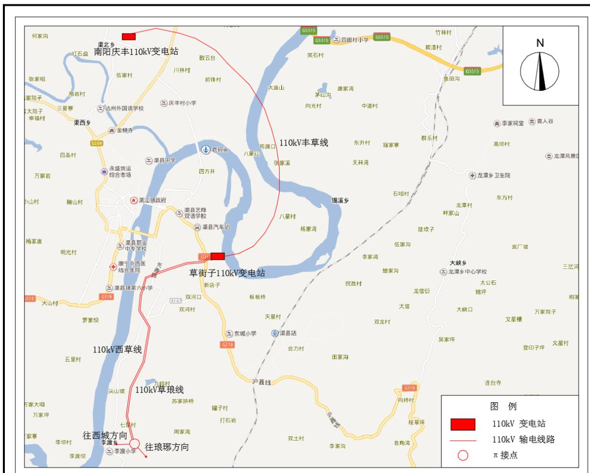
图 4-3 渠县草街子 35 千伏变电站升压改造输变电工程输电线路路径图
